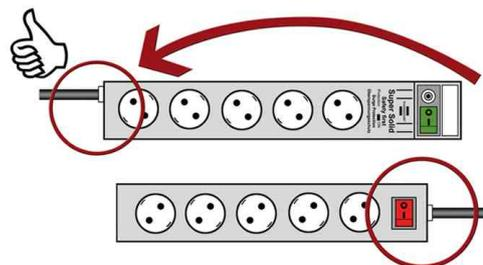
Image d'utilisation, câble à l'opposé de l'interrupteur
