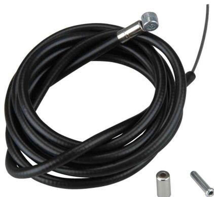
Fahrrad-Bremszug für Vorder- und Hinterrad
