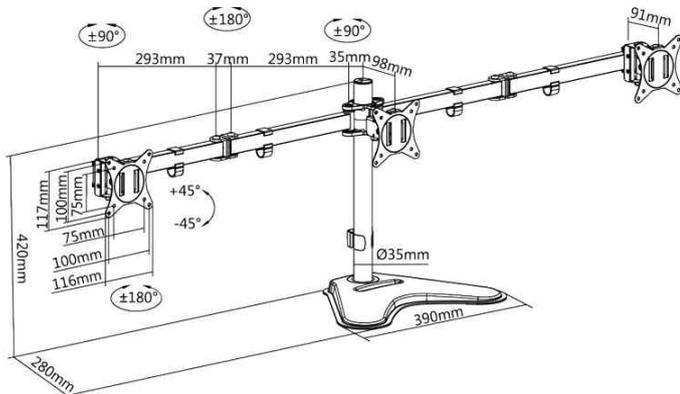
Dreifach-Monitorarm mit Standfuß - Abmessungen
